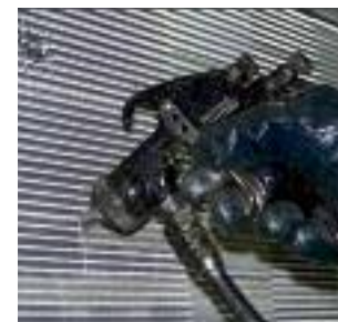
FIG. 7-8 Applicazione in stabilimento su scambiatore alettato.
